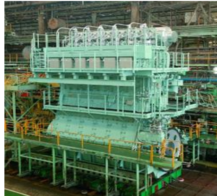
Hình 1. Động cơ Sulzer 6RT-FLEX50 (WARTSILA) trên bộ thử của nhà máy
