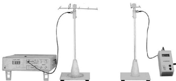
Hình 3a. Mô hình thí nghiệm đo đặc tính phương hướng của anten Yagi 5 chấn tử
