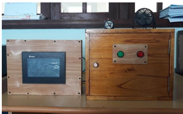
Hình 5. Tủ mô hình điều khiển và tủ giả lập sự cố khi hoàn thành
