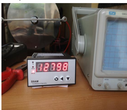
Hình 5. Đo cường độ tia UV thực tế bằng thiết bị đo chuyên dụng
