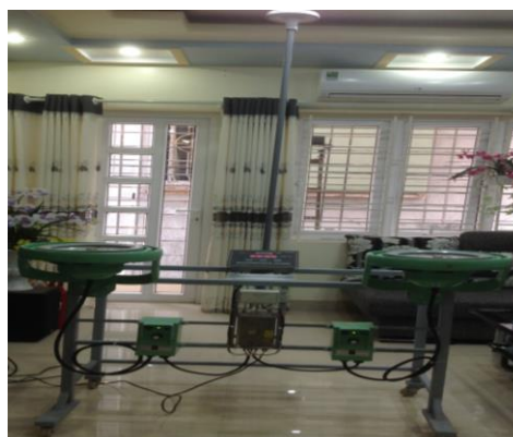
Hình 9. Hệ thống la bàn từ kỹ thuật số sau khi nghiên cứu, thiết kế và chế tạo
