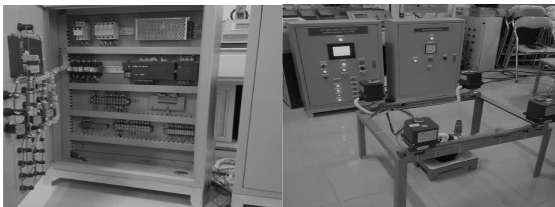
Hình 2. Phần cứng hệ thống điều khiển tự động chống nghiêng tàu thủy
