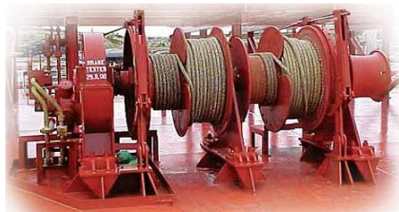
Hình 2. Tời dây tàu thủy với một động cơ lái nhiều trống tời
