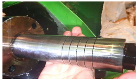
Hình 8. Tình trạng plunger sau khi vệ sinh
