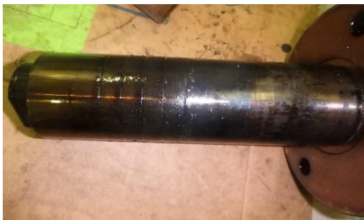
Hình 7. Tình trạng plunger khi được tháo ra
