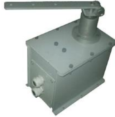
Hình 5. a) Đài lái tự động; b) Khối phản hồi góc bẻ lái
